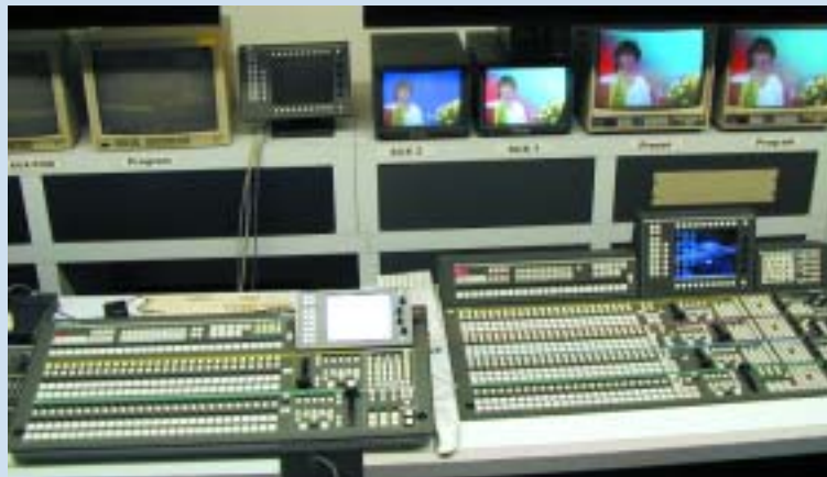
Der digitale Produktionsmischer DD35 2S (links) musste wesentlich kleiner werden als der Vorgänger (rechts).
