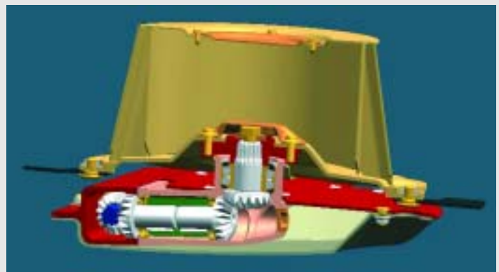
Kompaktes Mähscheiben-Getriebe, eines der vielen FELLA-Patente
